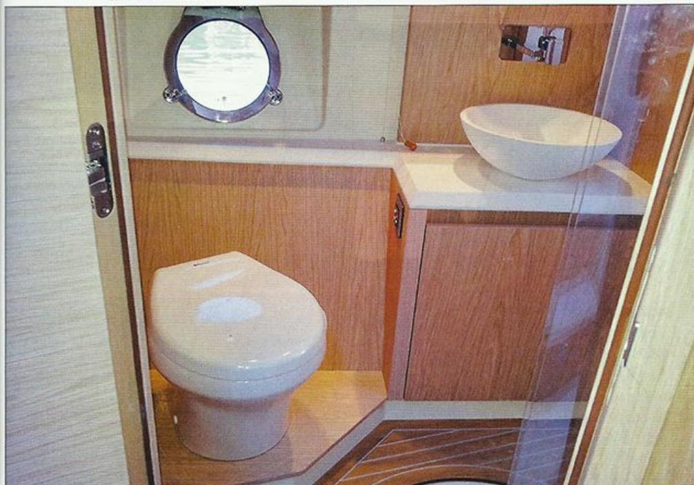
vacio del sistema en buenas condiciones de estanqueidad. El sistema Vacuflush utiliza un 75% menos de energía eléctrica (6 a 8 Amp) que un sistema de inodoro eléctrico estándar.
