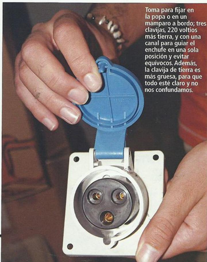
Toma para fijar en la popa o en un mamparo a bordo; tres clavijas, 220 voltios más tierra, y con una canal para guiar el enchufe en una sola posición y evitar equívocos. Además, la clavija de tierra es más gruesa, para que todo esté claro y no nos confundamos.
