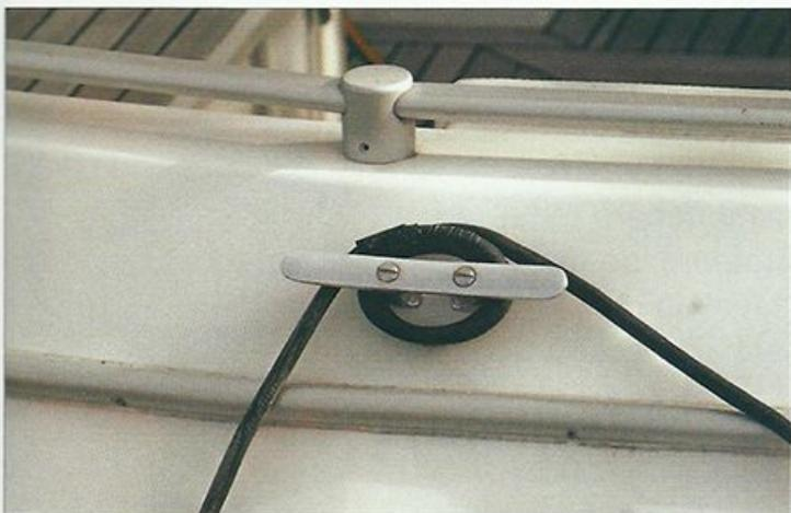
▲ Una vuelta del cable a un herraje del barco evitará que un tirón accidental lo arranque del enchufe y caiga al agua.
